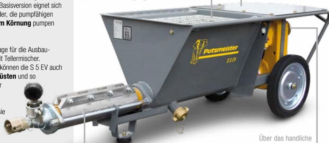
Der große Trichter hat ein Schutzgitter mit einem Sicherheitsschalter und fasst ganze 100 Liter. Das erlaubt eine zügige Verarbeitung des Materials. Das Schutzgitter kann extrem weit aufgeklappt werden. Das erleichtert den Zugang zum Fördertrichter (z. B. für die Reinigung).
