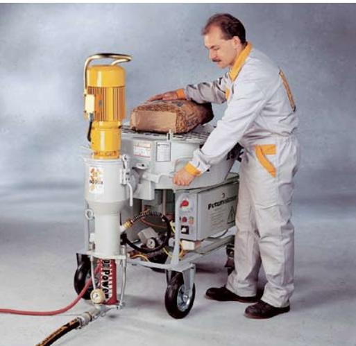
Materialbehälter und Mischrohr sind voneinander getrennt. Sie öffnen den Schieber und das Trockenmaterial gelangt ins Mischrohr.
